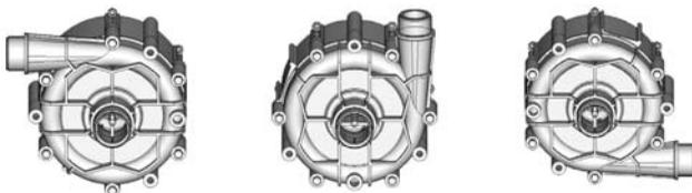
Рис. 8.3.1 В - Допустимое положение гидравлического блока
